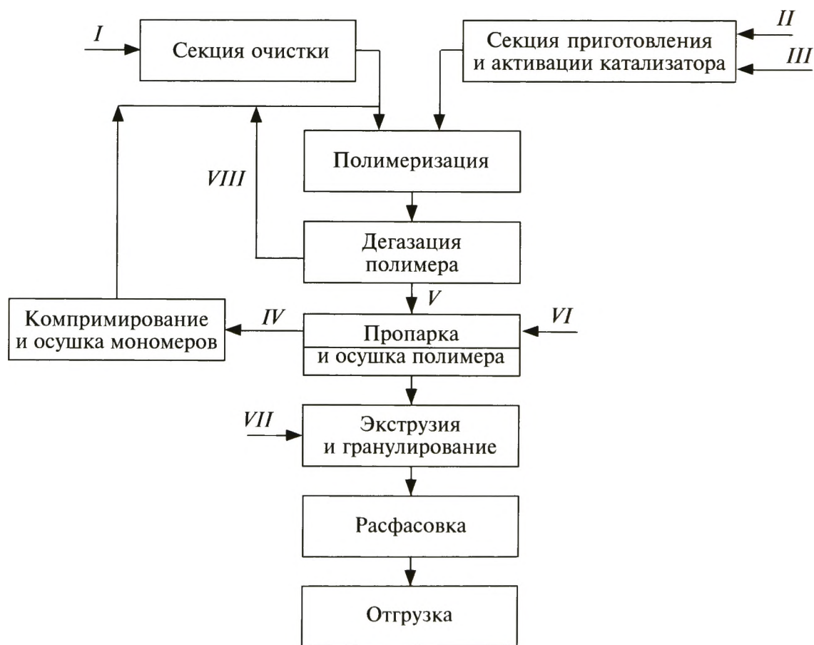
Рис. 6.18. Принципиальная блок-схема технологии производства полиэтилена:
