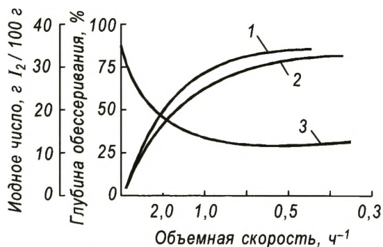
Рис. 5.2. Влияние объемной скорости подачи дистиллята коксования на глубину его обессеривания и иодное число:
